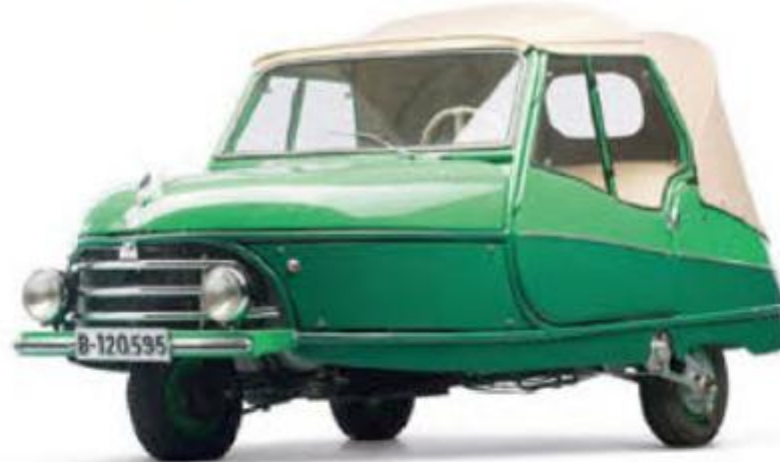
1958 David. Cette espagnole avec une roue unique à l'avant fut présentée comme « une moto avec une roue en plus ».
