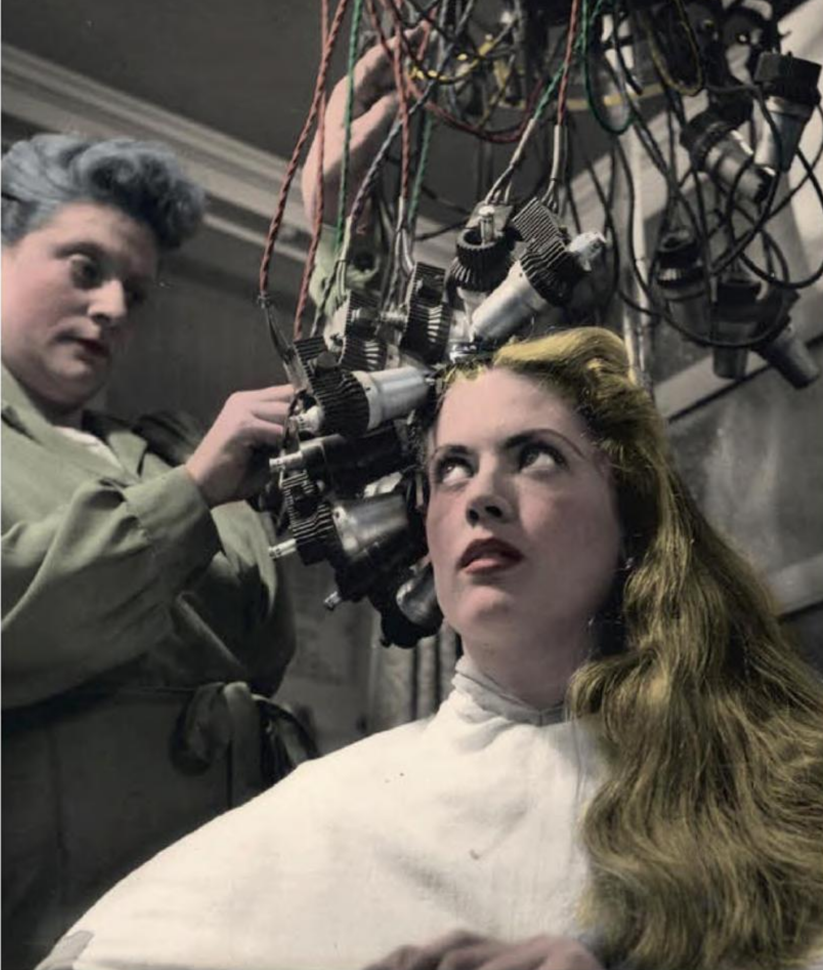
L'un des premiers modèles de machine à permanente, fin des années 1920.
