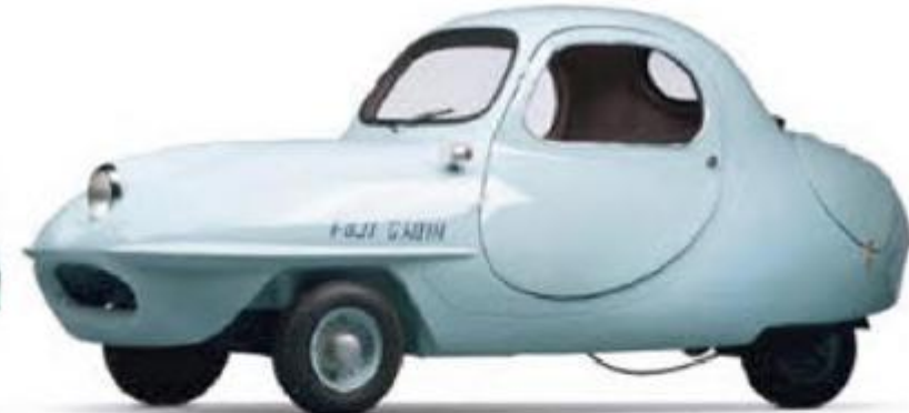
1955 Fuji Cabin. Une des rares microvoitures fabriquées au Japon. Elle possède une carrosserie en fibre de verre.
