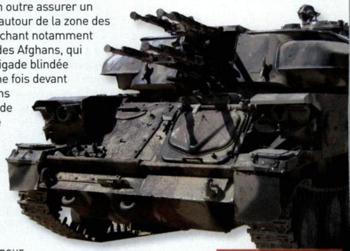
Le ZSU-23-4 *Shilka* — d'après le nom d'une rivière d'Asie orientale russe — est un blindé chenillé léger doté d'une tourelle à quatre canons antiaériens de 23 mm guidés par radar : un engin capable de tirer jusqu'à 4 000 coups par minute, dévastateur contre des cibles non protégées, et donc très prisé pour l'appui-feu. ZSU, pour *Zenitnaya Samokhodnaya Ustanovka*, signifie « affût antiaérien automoteur ».
