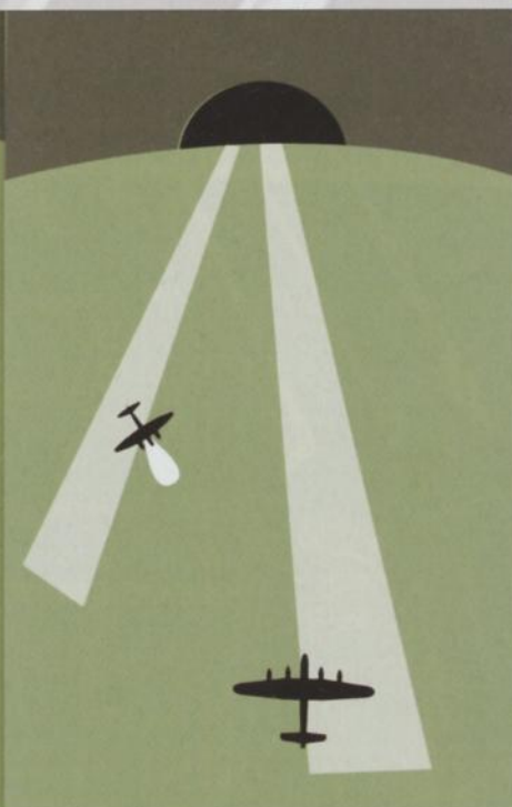
(2) Le radar localise le bombardier, se verrouille dessus et guide vers la cible le chasseur de nuit en patrouille.
