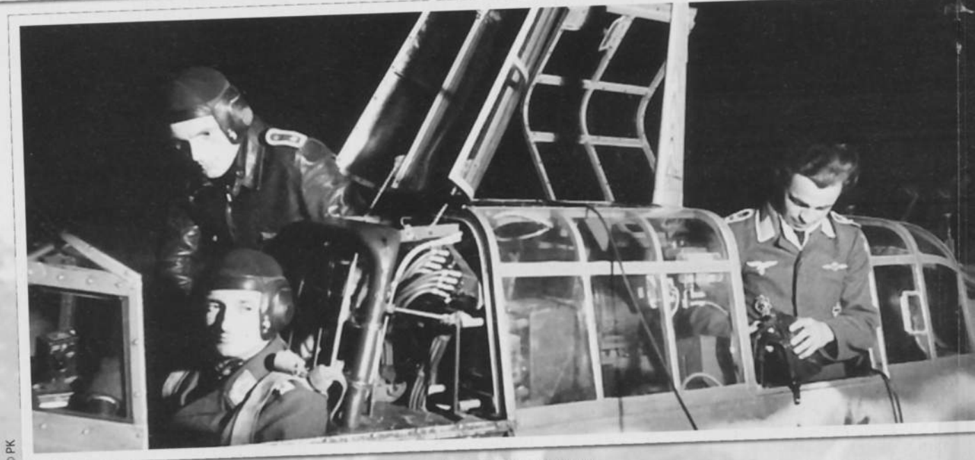
L'équipage du Hptm. Wilhelm Herget, menant le I./NJG 4. L'obligation d'emporter un équipement radar impliquait l'ajout d'un membre d'équipage supplémentaire. Les deux aviateurs embarquant habituellement dans un Bf 110 se voient ainsi adjoindre un troisième camarade.
