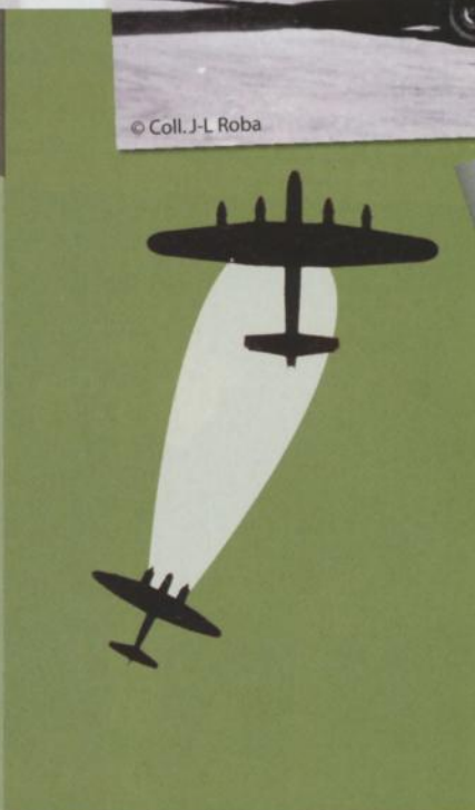
(3) Le radar « Lichtenstein » à courte portée de l'intercepteur prend la relève, se verrouille à courte distance sur le bombardier et le prend en chasse.
