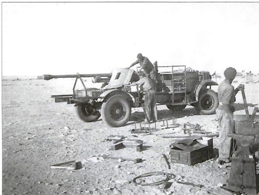
Voici un engin unique ! Il s'agit d'un camion léger Chevrolet 30CWT armé d'un canon antichar allemand Pak 38. Baptisé "la Revanche", ce véhicule a été bricolé par les mécaniciens de la Compagnie de Chars à l'initiative de Blasquez. Voir le plan de l'engin page d'en face. (Coll. Alain Le Floch)
