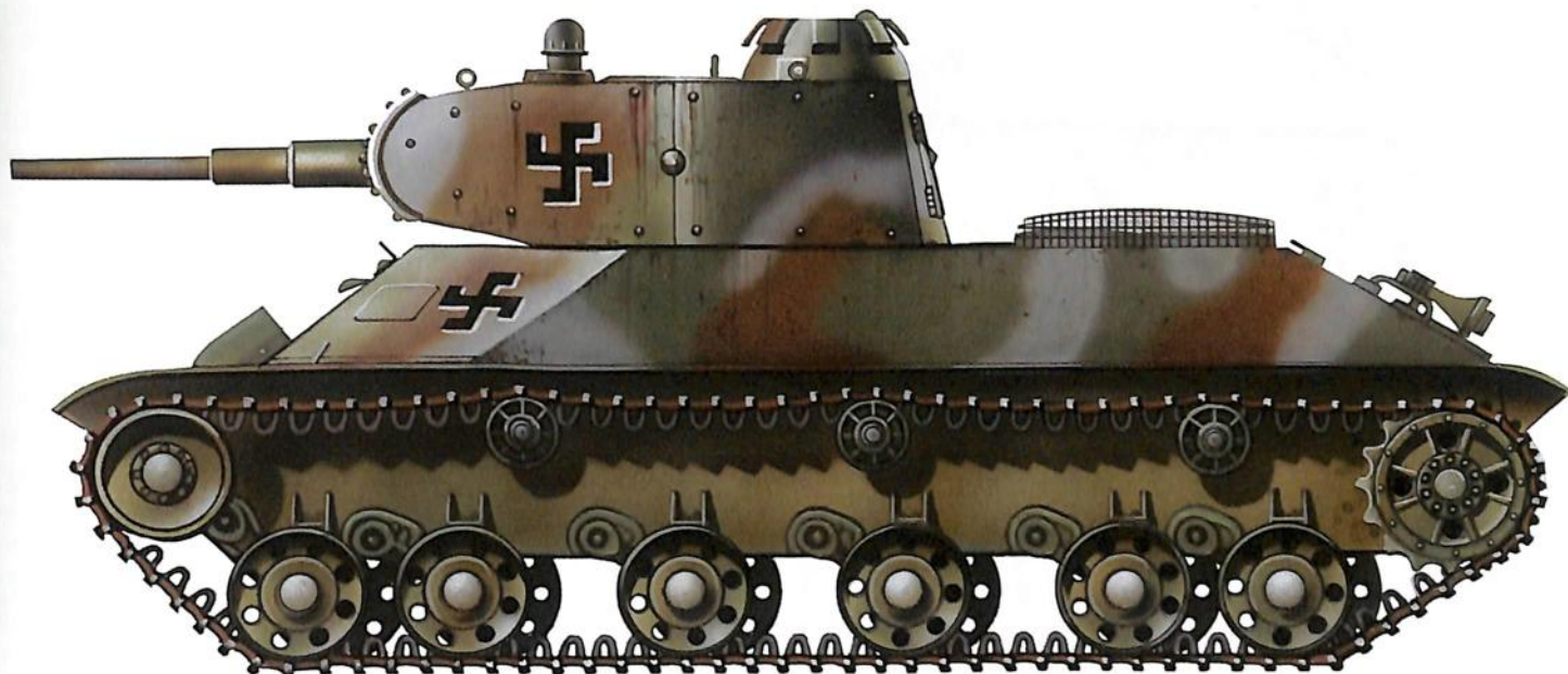
Chars T-50 capturés par les troupes finlandaises et réutilisés par ces dernières en 1942 (unités inconnues). Notez le surblindage riveté sur les tourelles.
