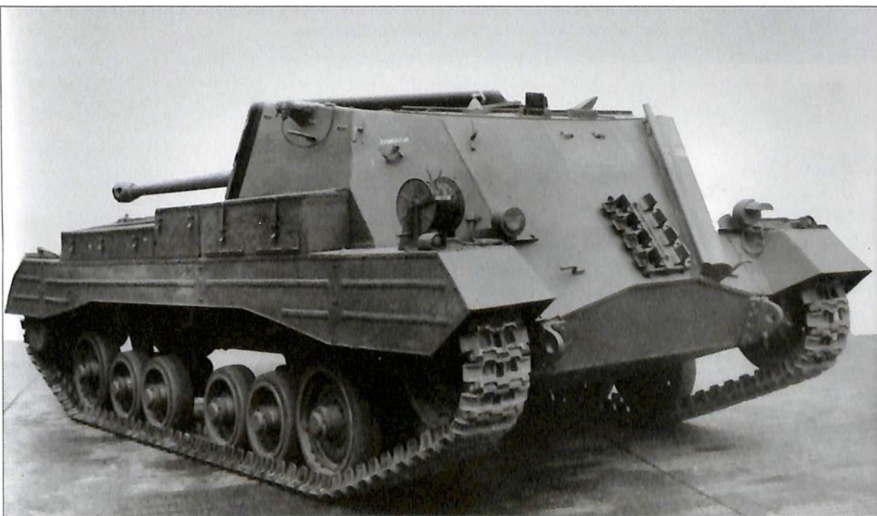
Self-Propelled Gun Archer , un engin réputé pour être aussi dangereux pour ses équipages que pour les Allemands... La pièce de 17-pdr est pointée vers l'arrière. Plus de 650 de ces engins seront produits et serviront avec l'Armée britannique en Europe ainsi qu'en Italie. (School of Tank Technology)
