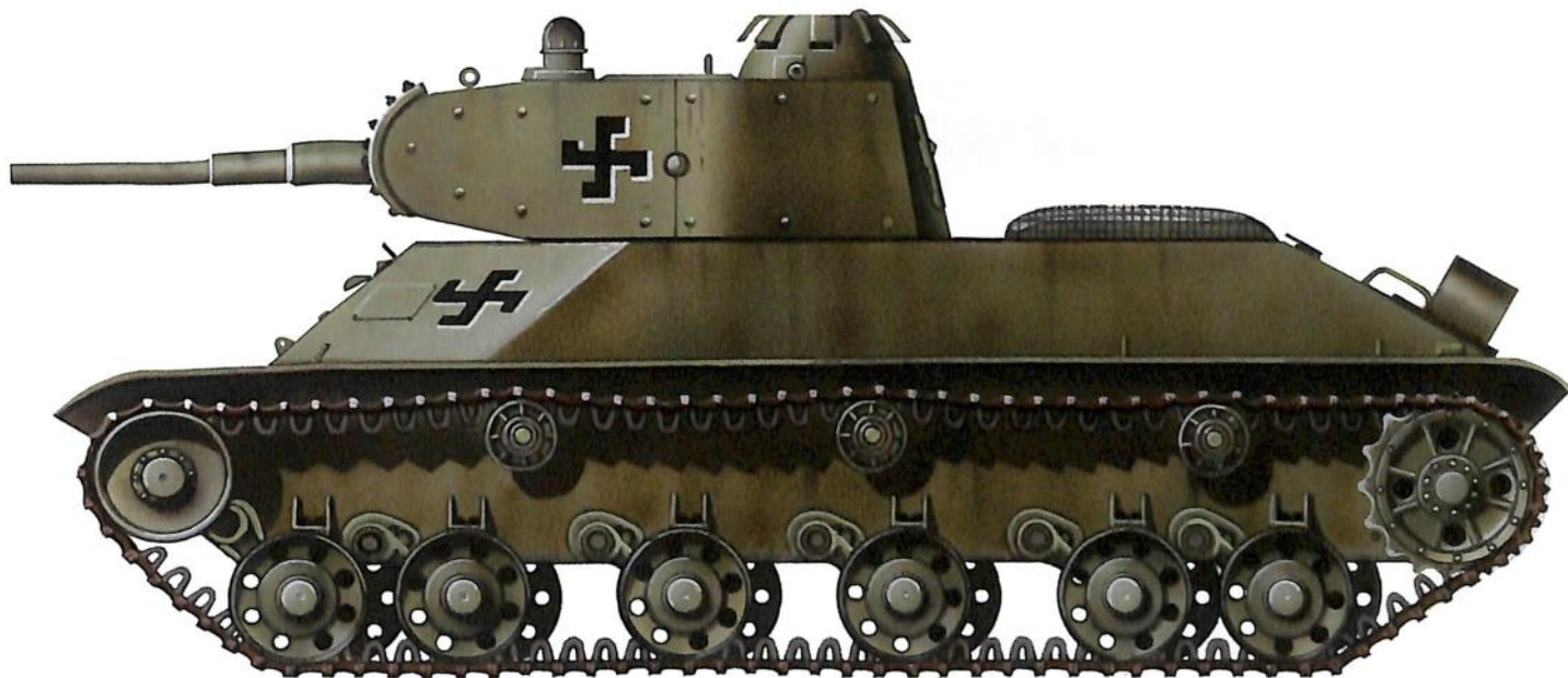
Chars T-50 capturés par les troupes finlandaises et réutilisés par ces dernières en 1942 (unités inconnues). Notez le surblindage riveté sur les tourelles.
