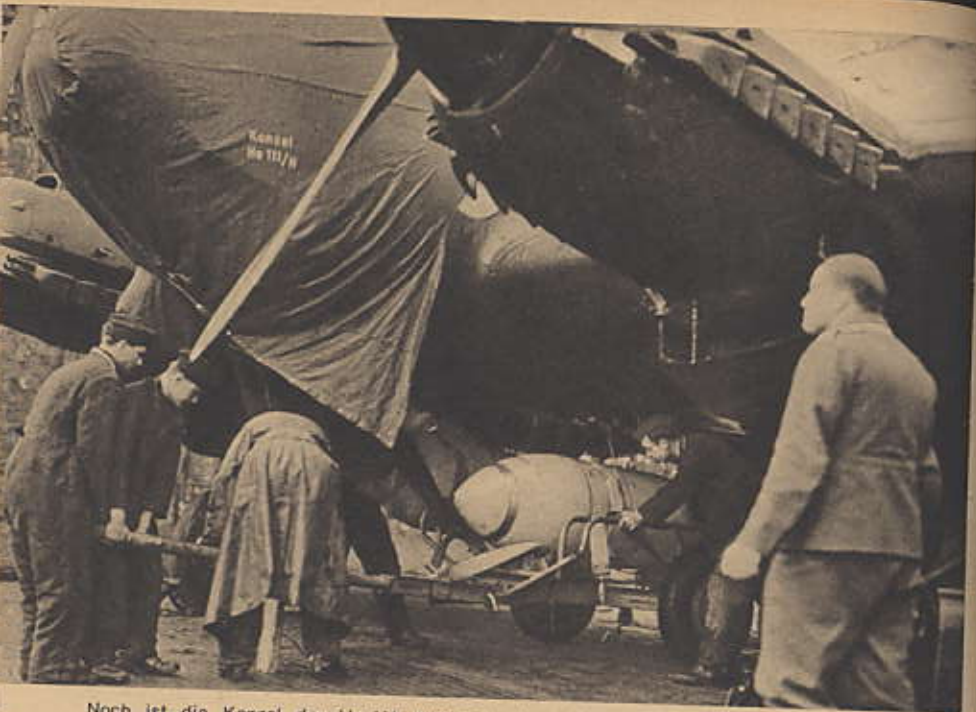
Noch ist die Kanzel der He 111 verhängt, aber schon ist das Bodenpersonal an der Arbeit. Bomben schweren Kalibers werden mit Hilfe eines Spezial-Hebewagens eingehängt.
