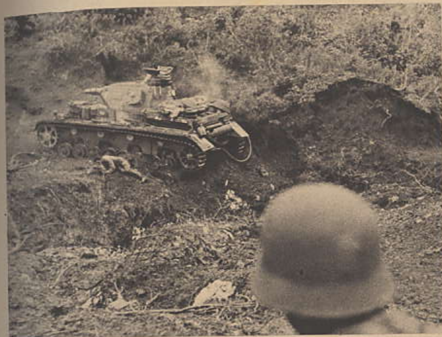
Eine furchtbare Detonation! „Achtung, Minen!“ ruft jemand, aber es ist halb so schlimm; trotz des ansehnlichen Minenkraters ist der Panzer nahezu unbeschädigt. Nur die rechte Kette ist aus der Führung gerissen und ein Mann, der aus dem Wagen gesprungen ist, leicht verletzt.
