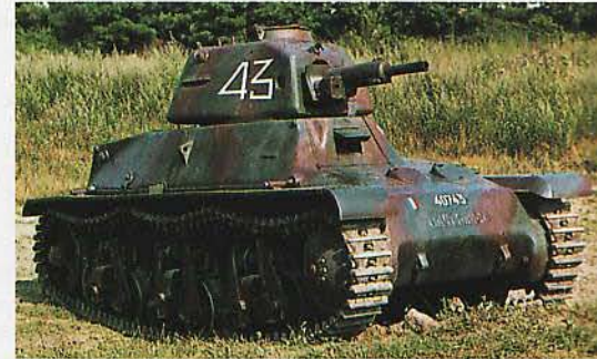
Le char léger HOTCHKISS H 39 (➔ pages 26-35) conservé au musée des blindés de Saumur présente le canon long de 37 SA 38, mais aussi le clocheton modifié à l'allemande. (DR)
