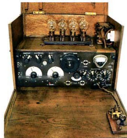
Poste E 13 second modèle à quatre lampes de réception. (Coll. M.G.)
