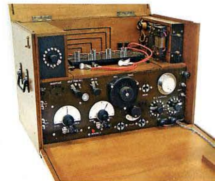
Poste E 13 à six lampes. L'émetteur est constitué de deux lampes de puissance dites « à cornes ». On distingue les fils pour le chauffage des filaments raccordés sur le dessus des tubes E 4, sur ses « cornes ». (Coll. M.G.)
