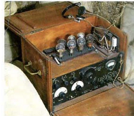
Le premier modèle d'E 13 à trois lampes de réception, modèle 1918. (Musée de Radio France, photo A. Salles)
