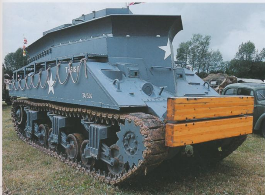
Le Sherman BARV, Beach Armoured Recovery Vehicle, était utilisé sur les plages par les hommes du Royal Electrical and Mechanical Engineers pour le dépannage des véhicules débarqués. A cette fin, sa coque étanche était surmontée d'une structure lui permettant d'évoluer dans la mer.
