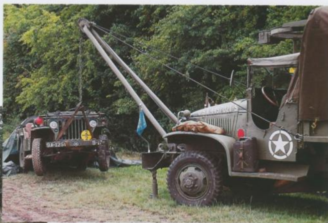
Certains G.M.C. de dépannage sont dotés de chèvres de levage montées à l'avant du véhicule.
