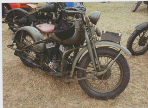
Les Harley Davidson sont souvent équipées d'une boîte à munitions ou à documents sur le côté gauche de la fourche avant, le côté droit étant occupé par le volumineux étui pour le pistolet mitrailleur Thompson au-dessus du phare, la sirène et, sur le côté, le feu de black-out.
