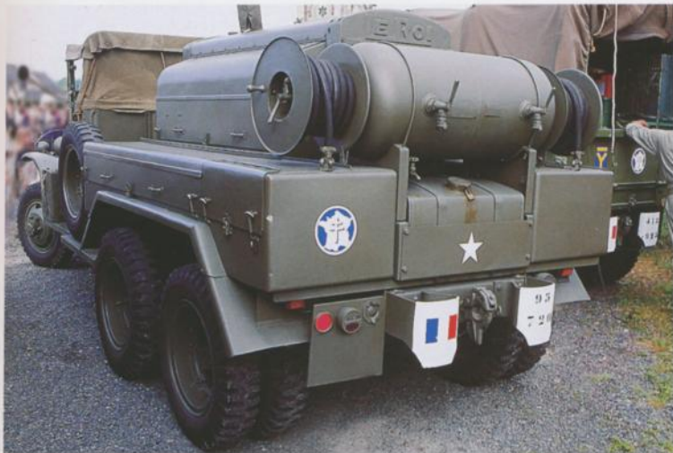
Le compresseur Leroy, vu de l'arrière : ici dans sa version française.
