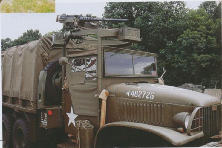
Pour la protection du véhicule : une mitrailleuse de cal. 12,7 montée sur rail circulaire...
