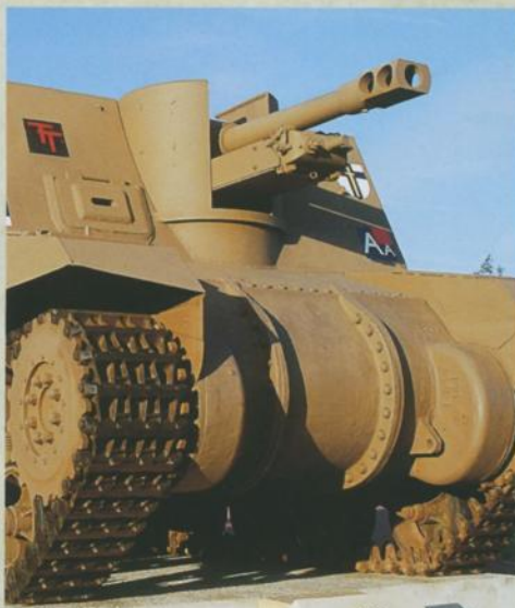
Le "Sexton", montage d'un canon sur châssis Ram canadien, est présent à la fois dans les unités blindées anglaises et canadiennes.
