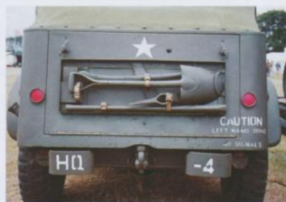
A gauche, on distingue la goulotte de remplissage du réservoir d'essence. A droite, les marquages réglementaires d'avertissement apposés à l'arrivée en Grande-Bretagne et avertissant les usagers que le véhicule a une conduite à gauche et pas de clignotants.
