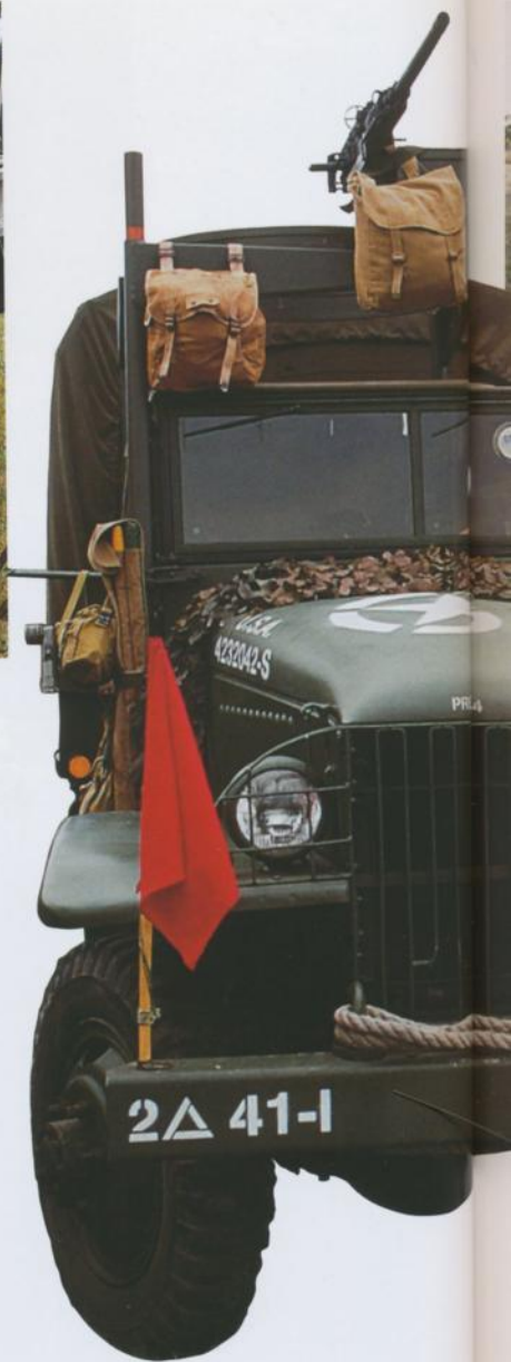
Pour la protection du véhicule : une mitrailleuse de cal. 12,7 montée sur rail circulaire...
