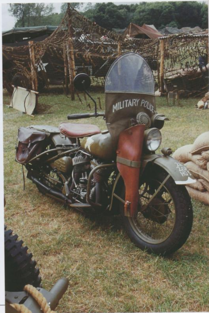
Les Harley Davidson sont souvent équipées d'une boîte à munitions ou à documents sur le côté gauche de la fourche avant, le côté droit étant occupé par le volumineux étui pour le pistolet mitrailleur Thompson au-dessus du phare, la sirène et, sur le côté, le feu de black-out.
