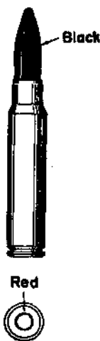
Figure 106. — Super-armor-piercing with tungsten carbide core ( Patronen Spitzgeschoss mit Stahlkern gehärtet ).
