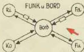
Die 4 Bordsprecher sind als Kreise eingezeichnet, Senden und Empfangen als Pfeile. Geht der Sendepfeil durch die Mikrofontaste, dann muß sie beim Sprechen gedrückt werden.
