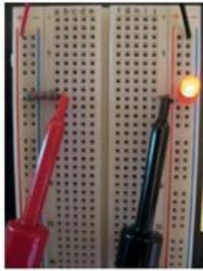
FIGURE 16-9 Pour mesurer l'intensité du courant, branchez le multimètre en série avec le circuit ou le composant concerné.
