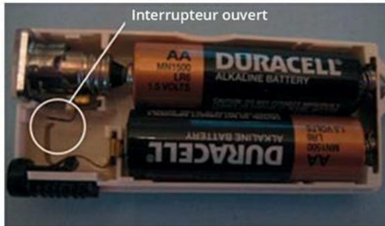
FIGURE 3-2 L'interrupteur étant ouvert, l'ampoule n'est pas connectée aux piles et le circuit est ouvert.
