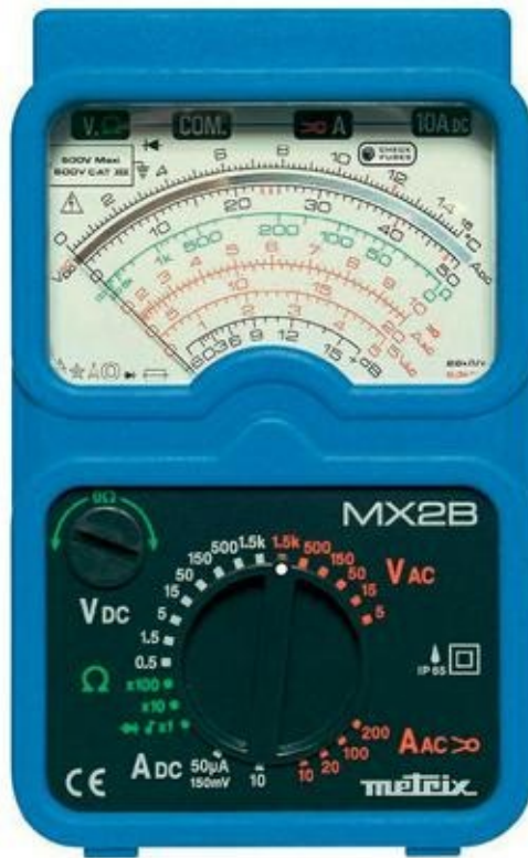
FIGURE 16-4 Sur ce multimètre analogique datant des années quatre-vingt, c'est une aiguille qui indique la tension, l'intensité, etc.
