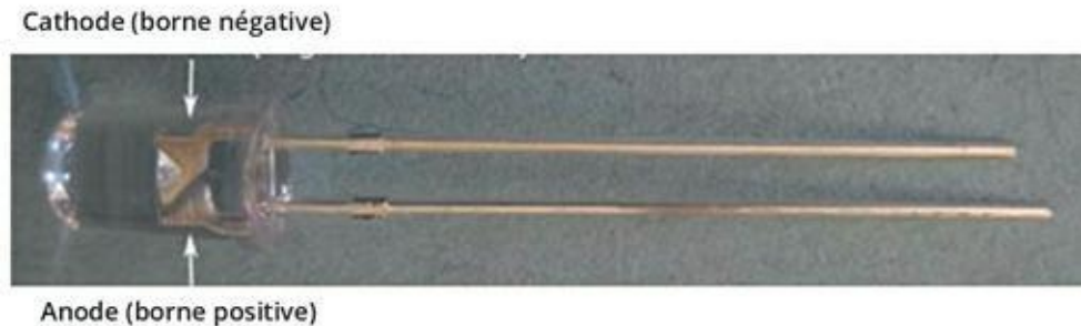
FIGURE 9-9 Sur une LED unicolore classique, la cathode (borne négative) est reliée à l'armature la plus grande à l'intérieur de la protection en plastique et à la branche la plus courte (sauf si l'on raccourcit les extrémités).
