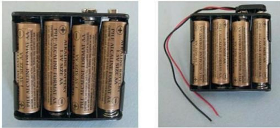
FIGURE 12-5 Quatre piles de 1,5 V branchées en série dans un compartiment à piles produisent une tension de 6 volts entre le fil rouge et le fil noir.
