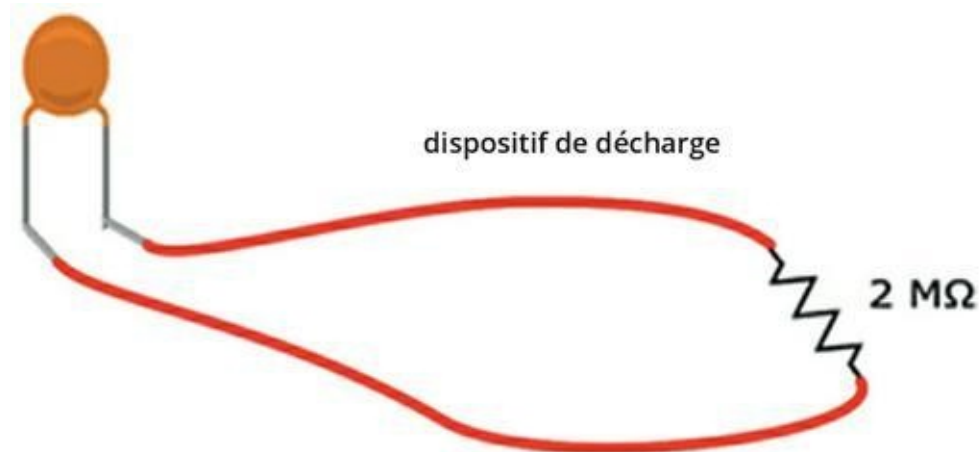
FIGURE 16-11 Achetez ou fabriquez un dispositif de décharge, utilisable pour drainer l'excès de charge d'un condensateur.
