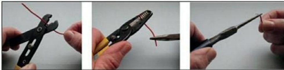
FIGURE 15-5 Couper, dénuder et tordre un fil d'interconnexion.
