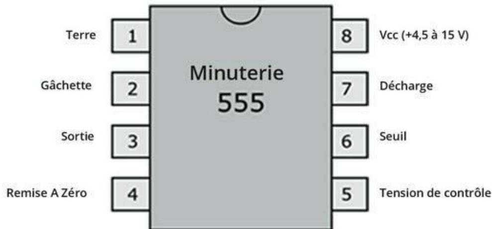
FIGURE 11-14 Brochage d'une minuterie 555.
