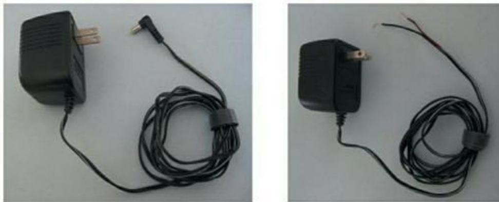
FIGURE 12-6 Cet adaptateur transforme le courant alternatif de 120 volts en courant continu de 7,5 volts et fournit jusqu'à 300 mA. J'en ai modifié la connexion pour pouvoir le brancher plus facilement sur mes circuits.
