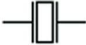
FIGURE 8-9 Ce symbole, en schématique, représente un cristal.
