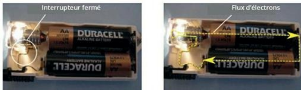
FIGURE 3-3 L'interrupteur étant fermé, le chemin conducteur est continu, si bien que les électrons peuvent circuler.
