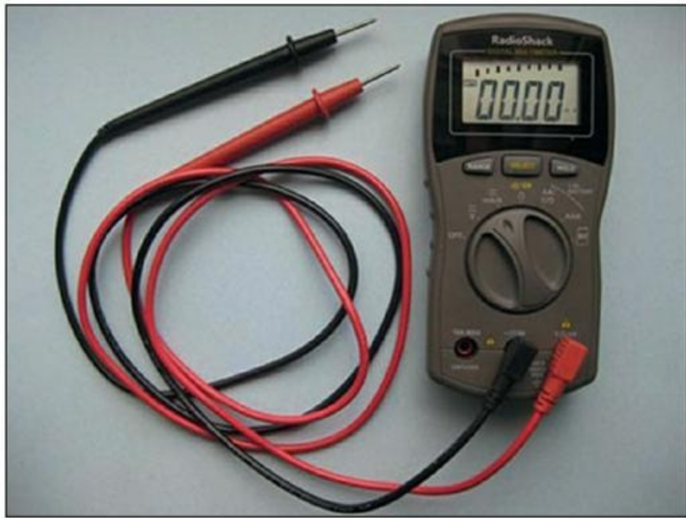
FIGURE 16-1 Un multimètre mesure la tension, la résistance, l'intensité et la continuité.
