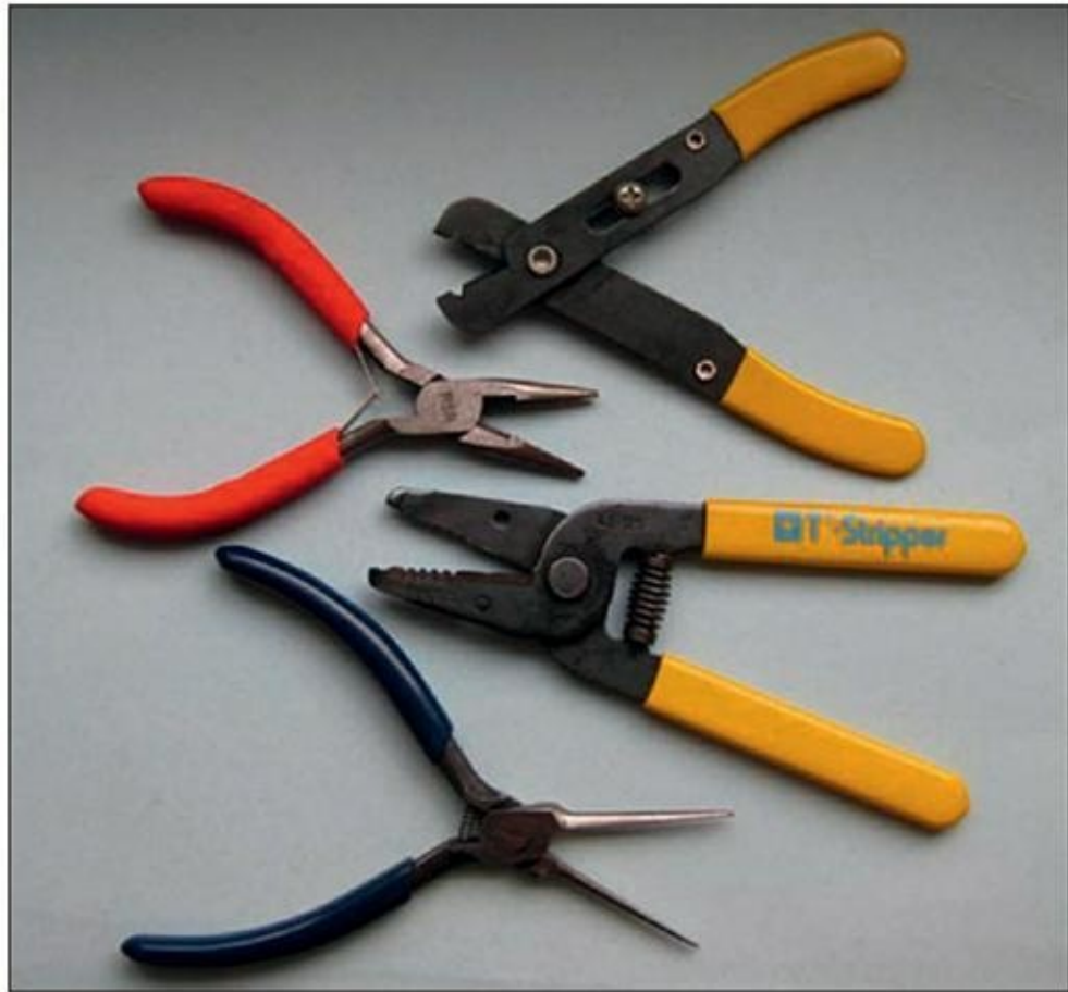
FIGURE 15-3 Les outils du métier, de haut en bas pince coupante et à dénuder, petite pince à bec fin, pince à dénuder, pince à bec fin.
