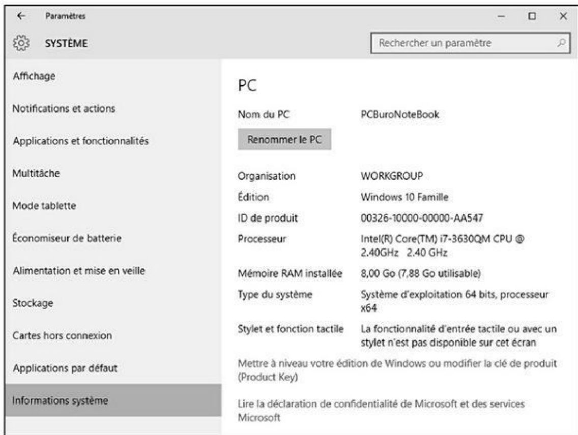
Figure 12.3 : La fenêtre Système indique quelle version de Windows vous avez (32 ou 64 bits).
