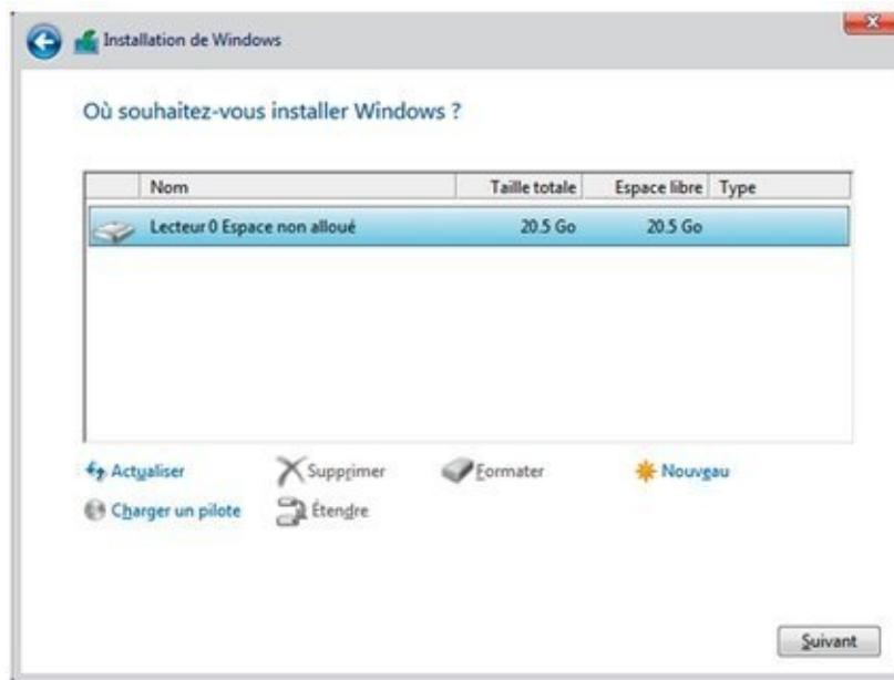
Figure 4.8 : Où installer Windows ?
