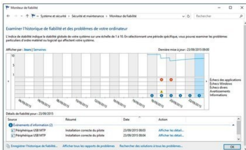
Figure 4.5 : Le Moniteur de fiabilité vous permet de déterminer le logiciel ou le matériel défectueux.
